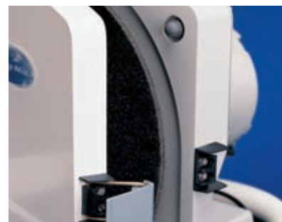
Los interruptores de seguridad incluyen: Interruptor de encendido/apagado e interruptor de seguridad de "Apagado por un desliz" a prueba de agua
