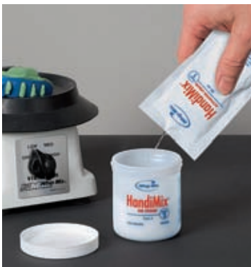
Agregue el contenido del activador líquido a la jarra de polvo
