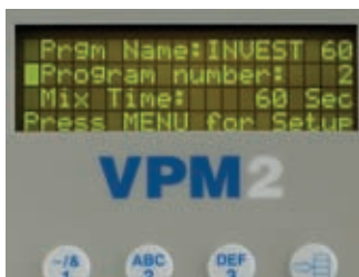
Pantalla LCD invertida muestra claramente parámetros y programas
