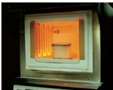
Quemado a temperatura máxima 30 minutos
