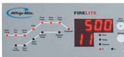
Indicador de estado LED que permite al técnico seguir las etapas de un programa mientras se ejecuta
